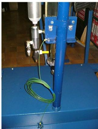
Collegare il quadro Atex, se in dotazione, alla rete elettrica 220Volts.
