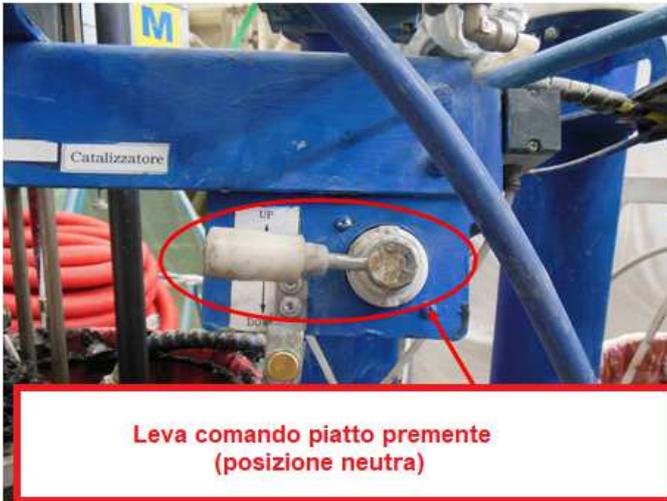
Attaccare i fermi al fusto vuoto del materiale. Incrementare lentamente la pressione del regolatore "ram extraction" a non più di 1.5 bar (20 psi).
