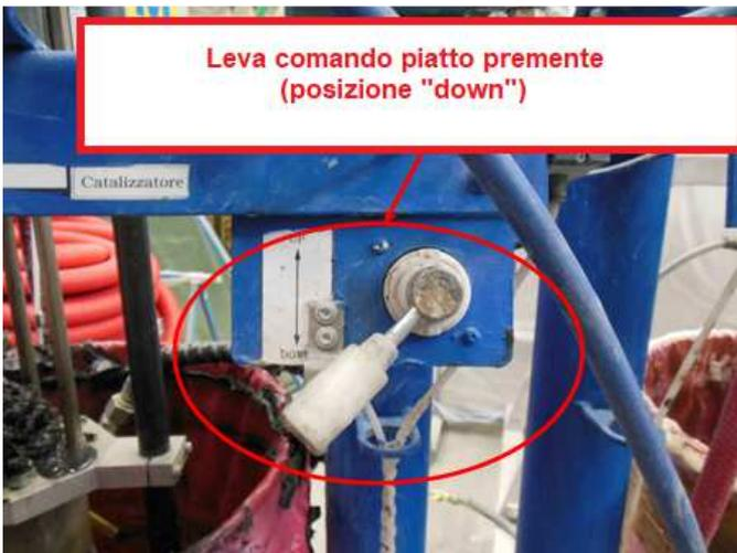
**4.1 Metodo per innescare la pompa del catalizzatore**
