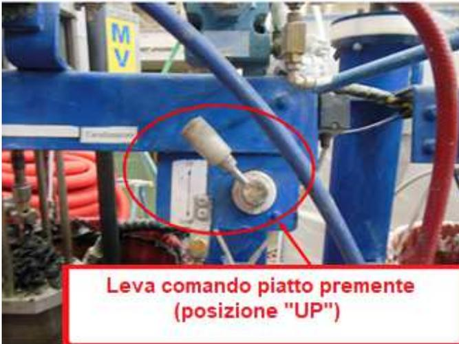
A questo punto si può procedere con la sostituzione del nuovo fusto.
