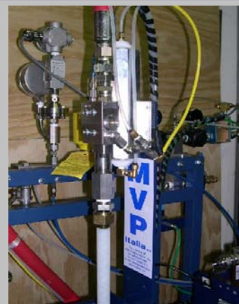
Miscelazione automatica - Portata fino a 30 Kg/min
